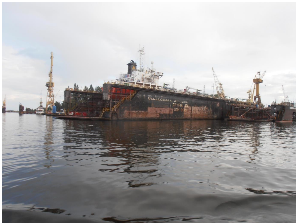
Rys. 2 Dla szcurów lądowych tak wygląda dok („podnośnik”) do remontu statków
